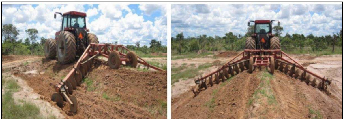
Figura 92 - Construção de terraço de base larga com arado terraceador Fonte: EMBRAPA, 2012
